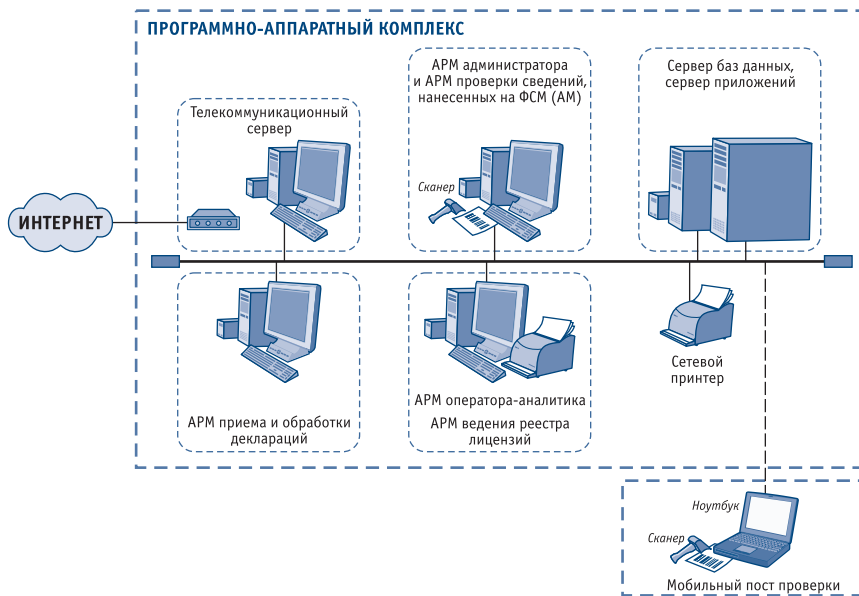
Рис. 11. Структурная схема ПАК уполномоченного органа субъекта РФ
